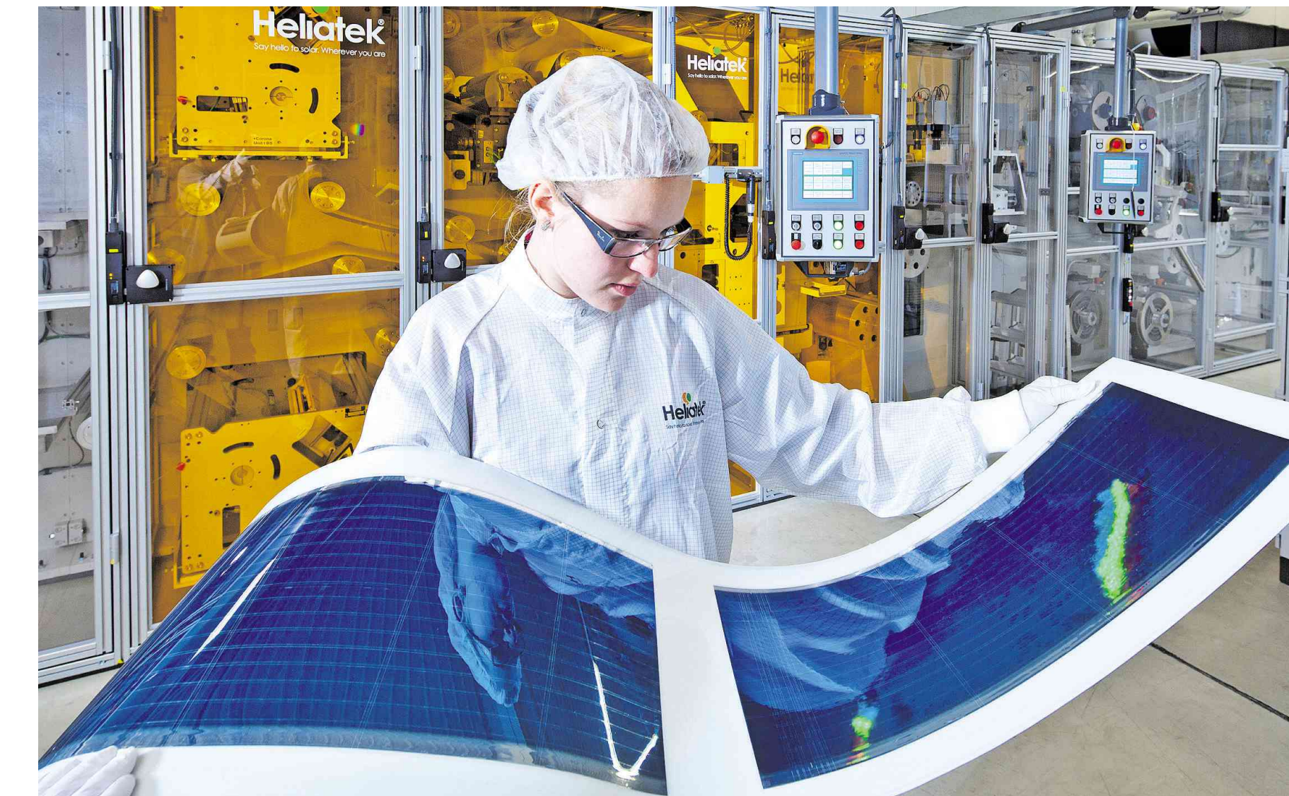
Solarfolien von Heliatek: Dünn und biegsam passen sie auf alle Oberflächen von Gebäuden, Autos und Zügen.
